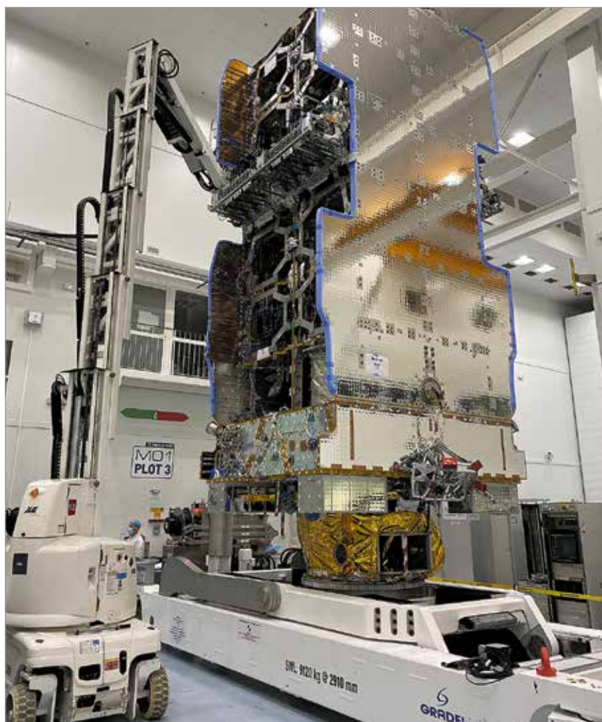
Der riesige, 6,5 Tonnen schwere Satellit SES-19 geht demnächst in Betrieb und bedient dann Nord- und Südamerika, die Karibik und den Flugverkehr über dem Atlantischen Ozean. Es ist der erste vollelektrische SES-Satellit, d. h. er hat keinen Brennstoff an Bord und benutzt auch für seine Positionskorrekturen ausschließlich Sonnenenergie. Die Transportmaschine, die ihn auf unserem Bild bewegt, ist übrigens ein Luxemburger Fabrikat und stammt von der Firma GRADEL aus Bad-Mondorf. © SES
